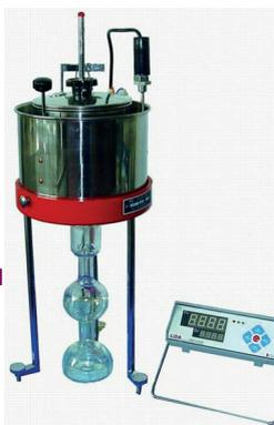
Mit dem Engler-Viskosimeter wird Erdöl untersucht – den Entwickler des Geräts finden Sie in den Chemiemeilensteinen 2025
