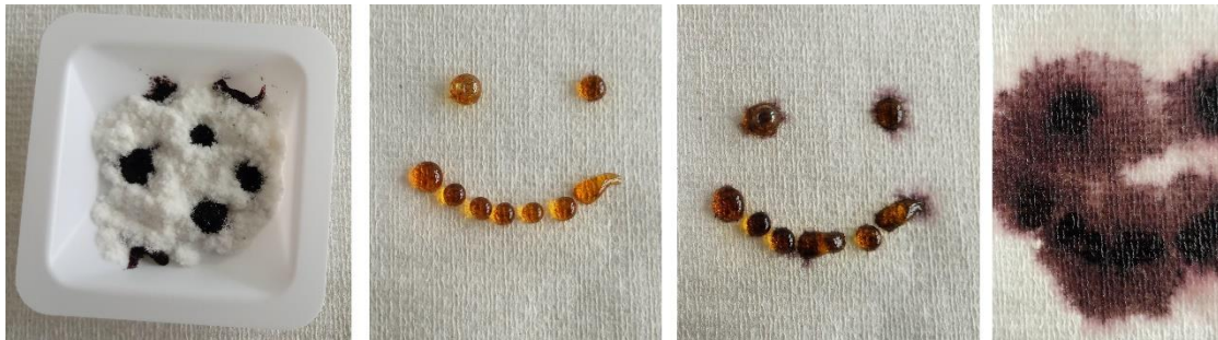
Abbildung 3: Cellulose-Nachweis mit Calciumchlorid-Iod-Kaliumiodid-Lösung
