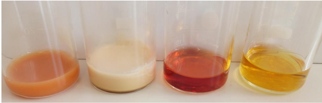
Abb. 16: 1,6-Diaminohexan-Verfahren (v.l.n.r. Vollmilch, lactosefreie Sahne, Lactose, Glucose) nach 60 Sekunden bei 400 W in der Mikrowelle (Foto: Rautenstrauch)
