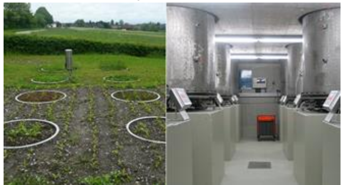
Abb. 1 Lysimeterkeller Wielenbach. Bild 1 Außenansicht, Bild 2 Innenansicht
