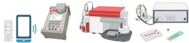
Abb. 2: Schematische Darstellung der antikörperbasierten Formate LFIA, FPIA, SAFIA und eines mikrofluidischen elektrochemischen Sensors (von links nach rechts).
