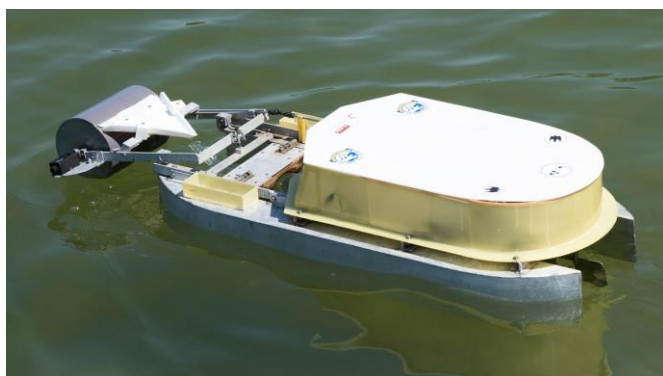
Abb. 1. Der INTERFACE 1 ist ein Probenehmer für Oberflächenwasserfilm. Hauptbestandteil des Probenehmers ist eine rotierende Trommel mit einem Abstreifer zum Sammeln der Wasserfilms.
