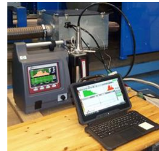
Abb.2: Sammlung der UFP mittels Impaktor ELPI+
