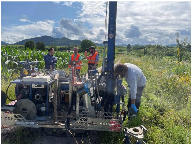
Abb. 4: Bohrungen zur Untersuchung auf PFAS-Kontaminationen des Grundwassers (Foto: P. Klatt)
