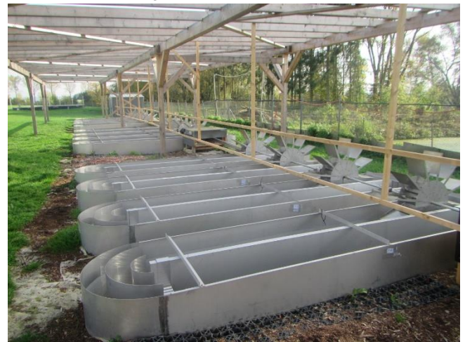
Abb.1: Rezirkulierende Fließgewässermesokosmosanlagen mit Schaufelradantrieb und optionalem Sonnenschutz
