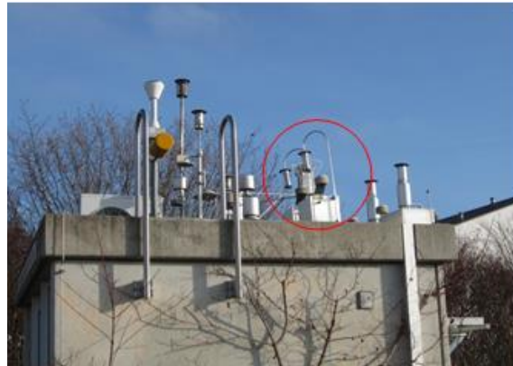
Abbildung 1: Luftmessstation Augsburg LfU. Die zwei Kleinfiltergeräte für die Luftprobenahme zur Bestimmung bromierter Flamm-schutzmittel befinden sich im roten Kreis.
