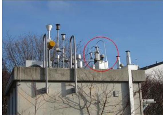
**Abbildung 1:** Luftmessstation Augsburg LfU. Die zwei Kleinfiltergeräte für die Luftprobenahme zur Bestimmung bromierter Flammenschutzmittel befinden sich im roten Kreis.
