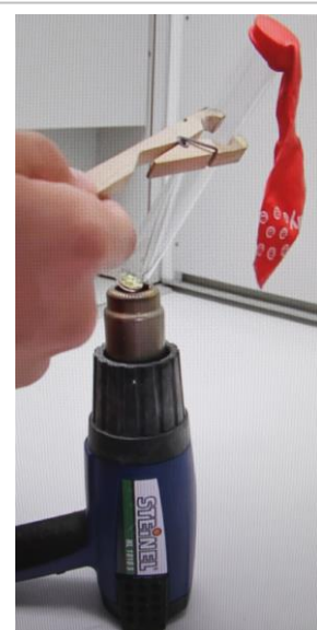
Erhitzen eines Kupfer-Schwefel-Gemisches mit dem Heißluftgebläse. (Foto: Horst Klemeyer)
