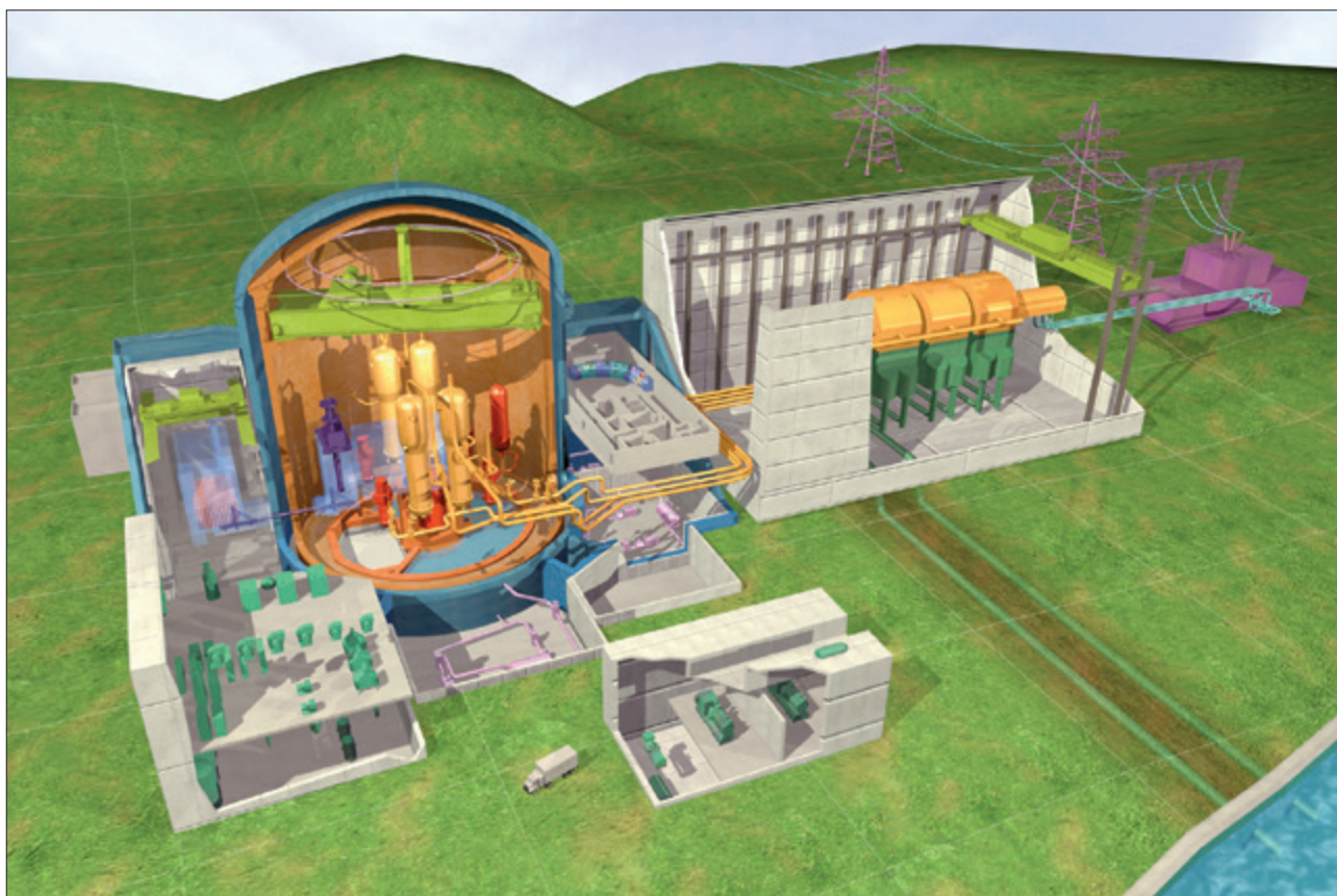
Schnitt durch den Aufbau des im Bau befindlichen EPR Reaktors in Olkiluoto, Finnland. Dabei handelt es sich um einen Kernspaltungsreaktor der III. Generation. (© AREVA)
