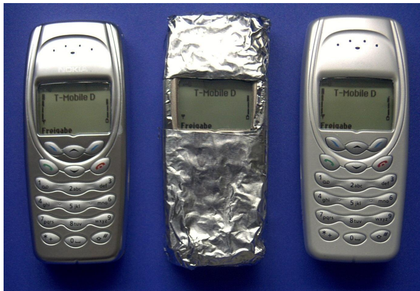
Abb. 1 Drei identische Mobiltelefone mit unterschiedlicher Lackierung bzw. Ausrüstung: Metallic, Al-Folie, Perlglanz. Beachten Sie die Antenneneingangssignale!
