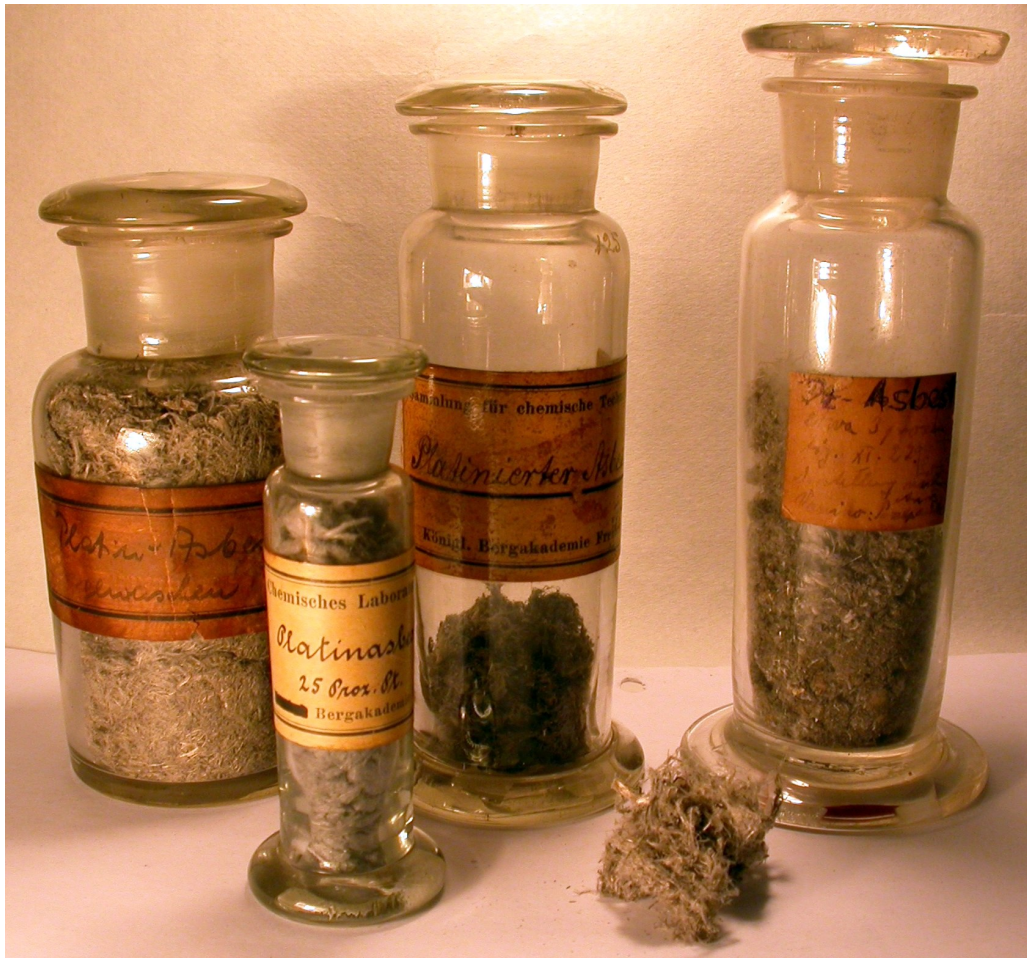
Abb. 4: Einige Proben der von Winkler hergestellten Katalysatorsubstanzen blieben in der Sammlung Chemischer Präparate der TU Bergakademie Freiberg als einmalige Zeugnisse der Chemiegeschichte erhalten. Sein Verfahren zur Herstellung von platinierterem Asbest wurde 1878 patentiert. Alle frühen Kontaktanlagen arbeiteten mit Platinkatalysatoren, erst ab den 1920er Jahren wurde das Edelmetall verstärkt durch das billigere und arsenunempfindlichere Vanadiumpentoxid verdrängt. Foto: Haustein.
