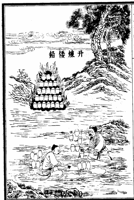
Abb. 2: Raffinieren von Zink in geschlossenen Reaktionsgefäßen
