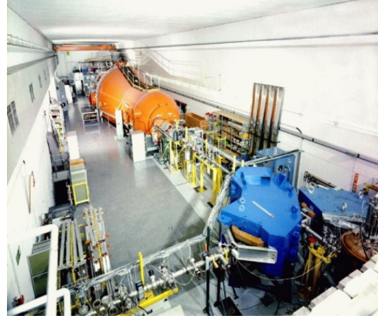
Ein „kleiner“ Anteil der AMS Anlage an dem MLL-TUM: der orange 14 MV Tandem Beschleuniger und der blaue 90^\circ Magnet.
