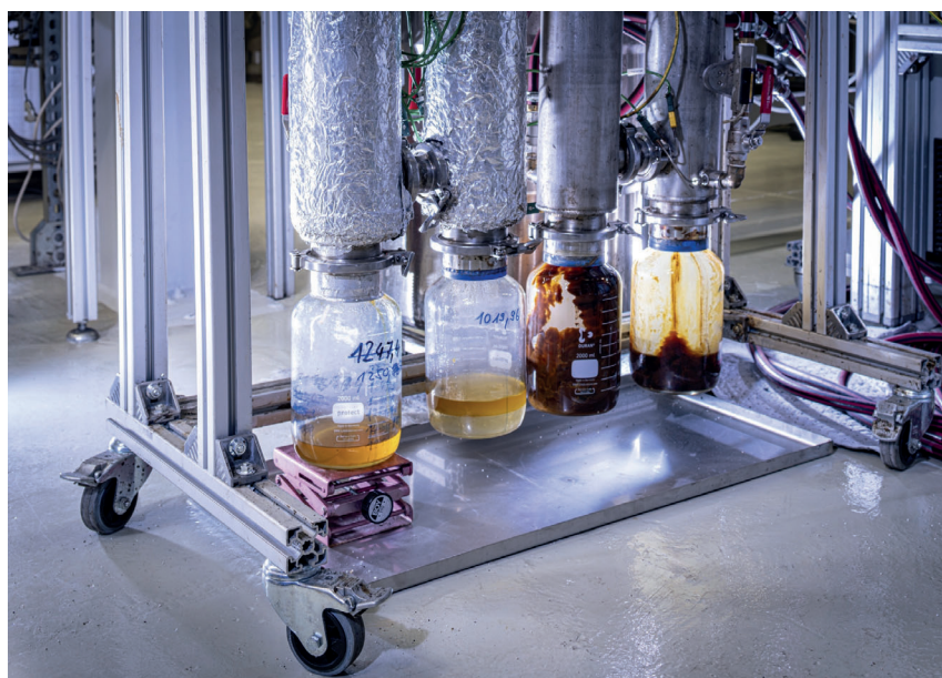
Typische Kondensationsstufen für Pyrolyseöl am Pyrolysereaktor (Foto: KIT/ITC)
