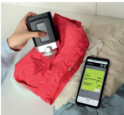
Abb. 3. Mobile NIR-Technologie zur Textilsortierung (Foto: trinamix)
