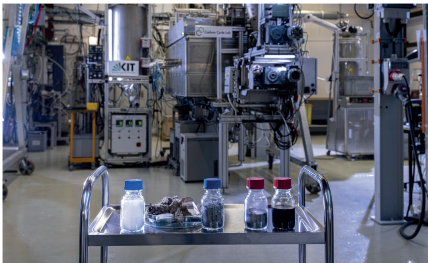
Erzeugung von Pyrolyseölen aus Kunststoffabfällen am Pyrolysereaktor des Instituts für Technische Chemie am KIT (Foto: KIT/ITC)
