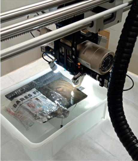
Mit einem mobilen XRF-Spektrometer, das im Städelmuseum in Frankfurt am Main untergebracht ist, wurden Fossilien aus der Grube Messel erstmals – zum Teil mehrere Stunden lang – gescannt. (Foto: Senckenberg/A. Vogel)
