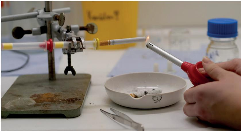
Abb. 3. Carbonylverbindungen aus Zigarettenrauch werden nach Probenahme mittels Derivatisierung bestimmt.
