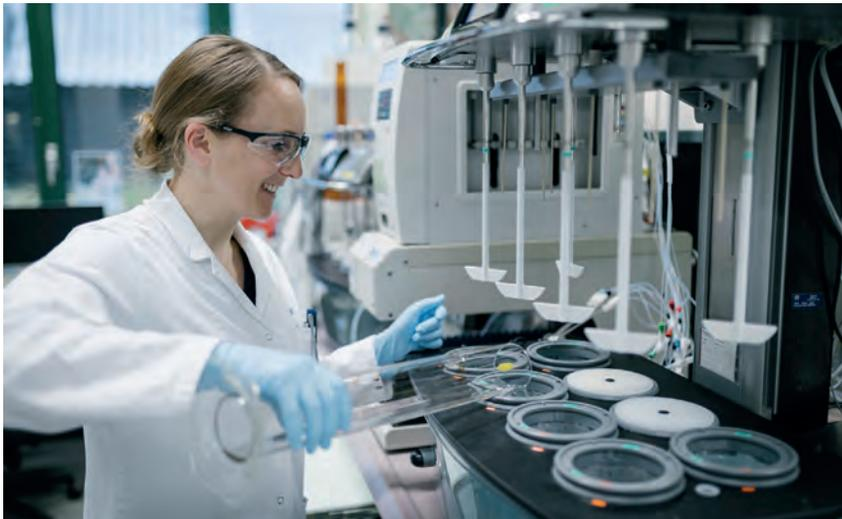
Blattrührerapparatur („Apparatur 2“), hiermit untersucht man die Wirkstofffreisetzung.
