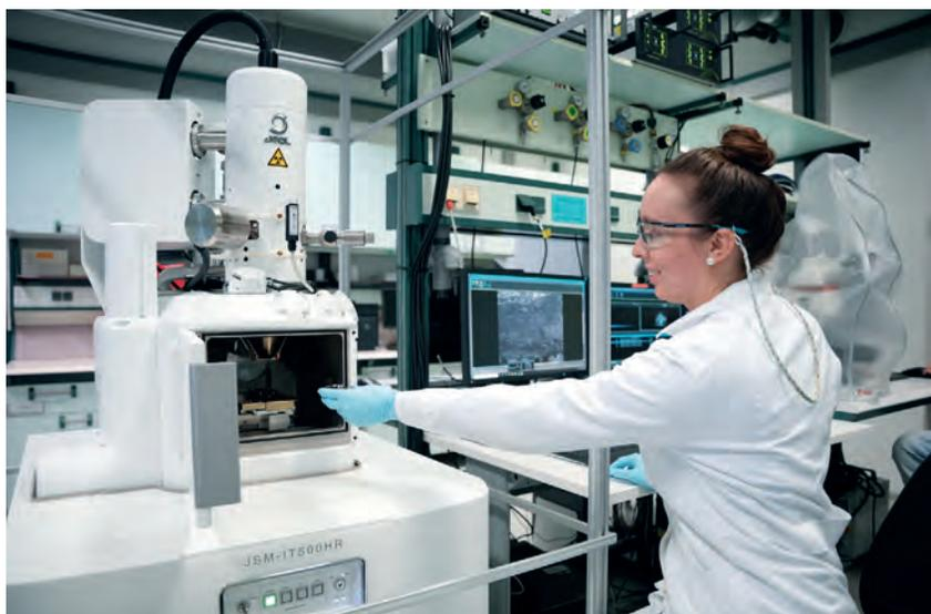
Elektronenmikroskop mit energiedisperser Röntgenspektroskopie
