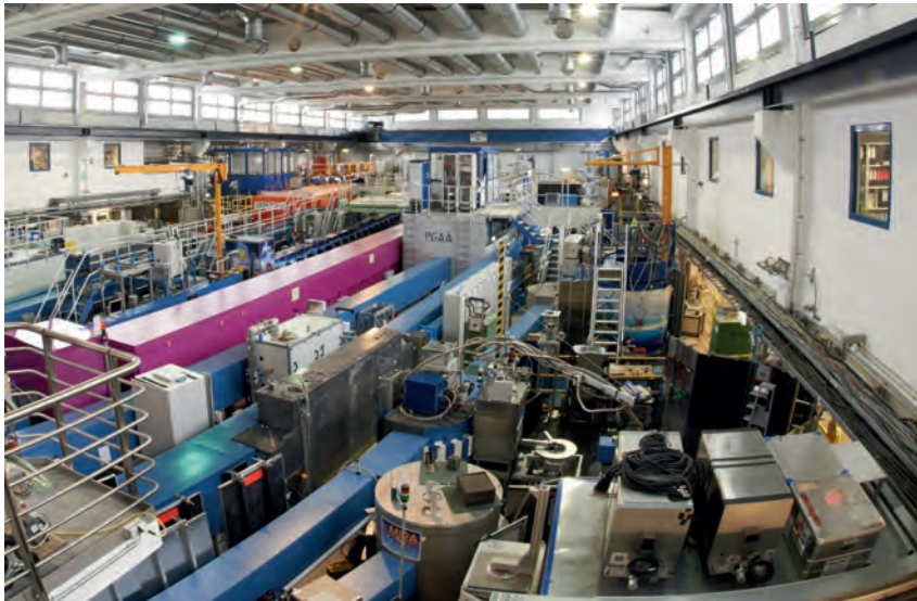
Abb. 2. Das Instrument der Prompte-Gamma-Aktivierungsanalyse (Bildmitte) wird über einen Neutronenleiter mit Neutronen versorgt. (Foto: W. Schürmann, FRM II / TUM)
