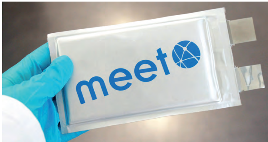
Eine assemblierte Pouch-Bag-Zelle eines Lithium-Polymer-Akkus aus dem MEET-Batterieforschungszentrum (Foto: MEET/WWU)
