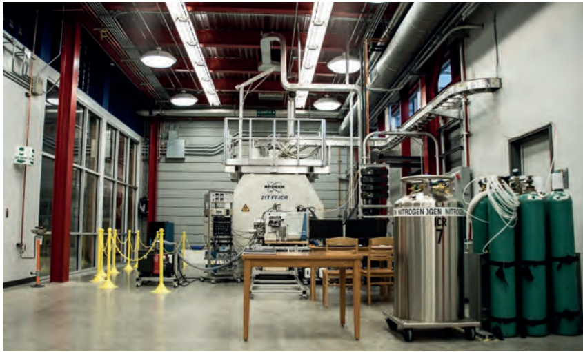
Das 21T-FT-ICR-MS im National High Magnetic Field Lab in Tallahassee, USA (Foto: National Maglab)
