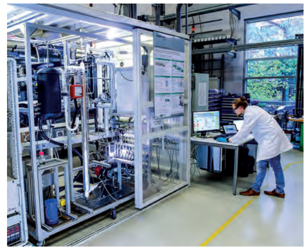
Scale-Down-Miniplant zur Erforschung der Methanolsynthese (Foto: Fraunhofer ISE)
