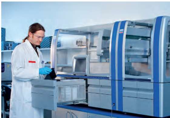
All-Inclusive-Geräte führen den gesamten PCR-Test vollautomatisch durch, mitsamt Extraktion und Säuberung der Nukleinsäure. (Foto: Qiagen)
