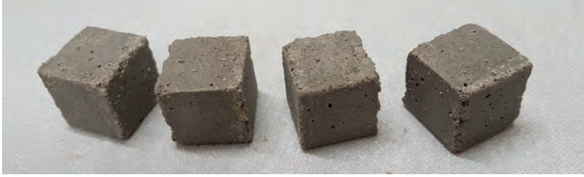
Simon Blotevogels Analyseobjekte: Mörtelwürfel zur Festigkeitsprüfung kleiner Mengen hüttensandhaltiger Zemente (Foto: L. Doussang)
