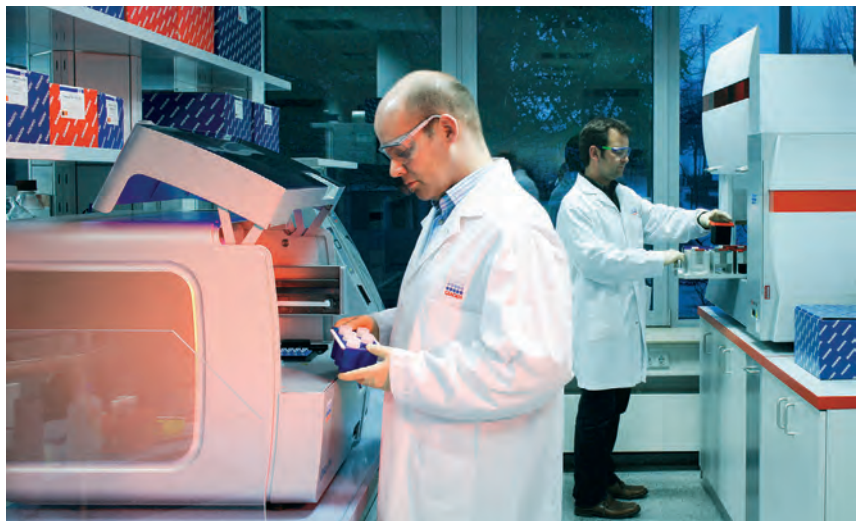
Abb. 1. Bei der Echtzeit-Polymerasekettenreaktion wird das Erbgut des Erregers vervielfältigt und per Fluoreszenz identifiziert. Die verwendeten Geräte sind eine Kombination aus einem Thermocycler und einem Fluoreszenzanalysator. (Foto: Qiagen)
