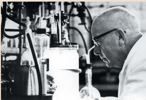
Die „Ziegler-Polymerisation“ im Laborversuch: Das Weckglas ist mit schneeweißem Polyethylen gefüllt.
