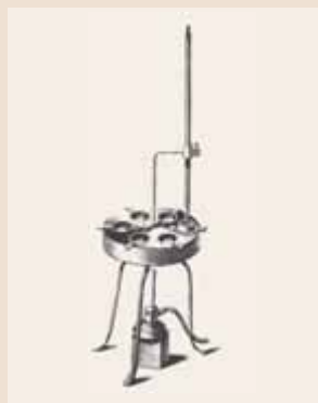
Abb. 3. Fresenius: Anleitung zur quantitativen chemischen Analyse, 4. Aufl., 1858: „Für technische und agricultur-chemische Untersuchungen, bei denen eine Anzahl von Proben zugleich bei höherer Temperatur getrocknet werden sollen, empfehle ich die in Fig. 36 dargestellte, von mir construirte Trockenscheibe“
