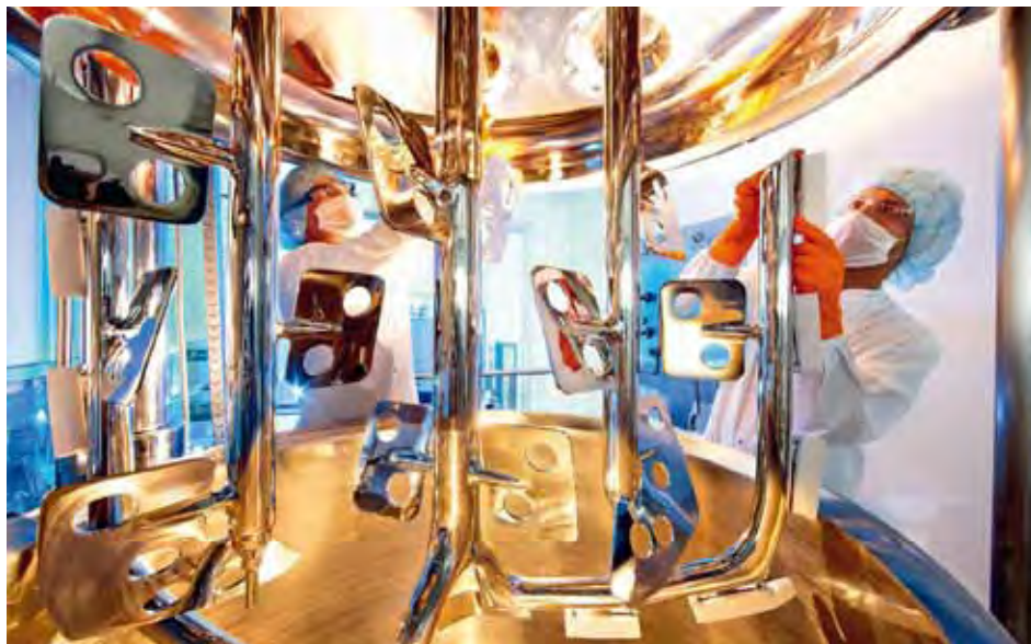
Salbenmischer zur Herstellung von Bepanthen Wund- und Heilsalbe (Foto: Bayer HealthCare AG).
